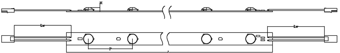
关于公差: 长度 $\pm 2\text{mm}$ , 宽度 $\pm 0.2\text{mm}$ , 高度 $\pm 0.2\text{mm}$ ;
